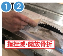
安全カバーを外し、細かい木片を切断
